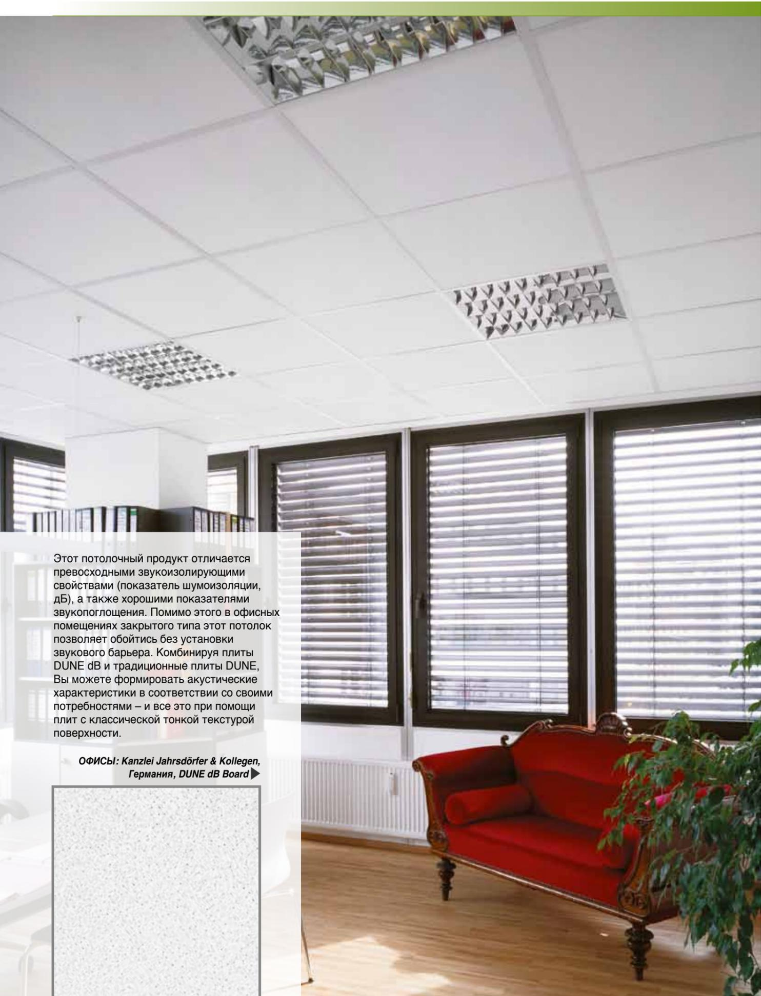
Этот потолочный продукт отличается превосходными звукоизолирующими свойствами (показатель шумоизоляции, дБ), а также хорошими показателями звукопоглощения. Помимо этого в офисных помещениях закрытого типа этот потолок позволяет обойтись без установки звукового барьера. Комбинируя плиты DUNE dB и традиционные плиты DUNE, Вы можете формировать акустические характеристики в соответствии со своими потребностями – и все это при помощи плит с классической тонкой текстурой поверхности.
