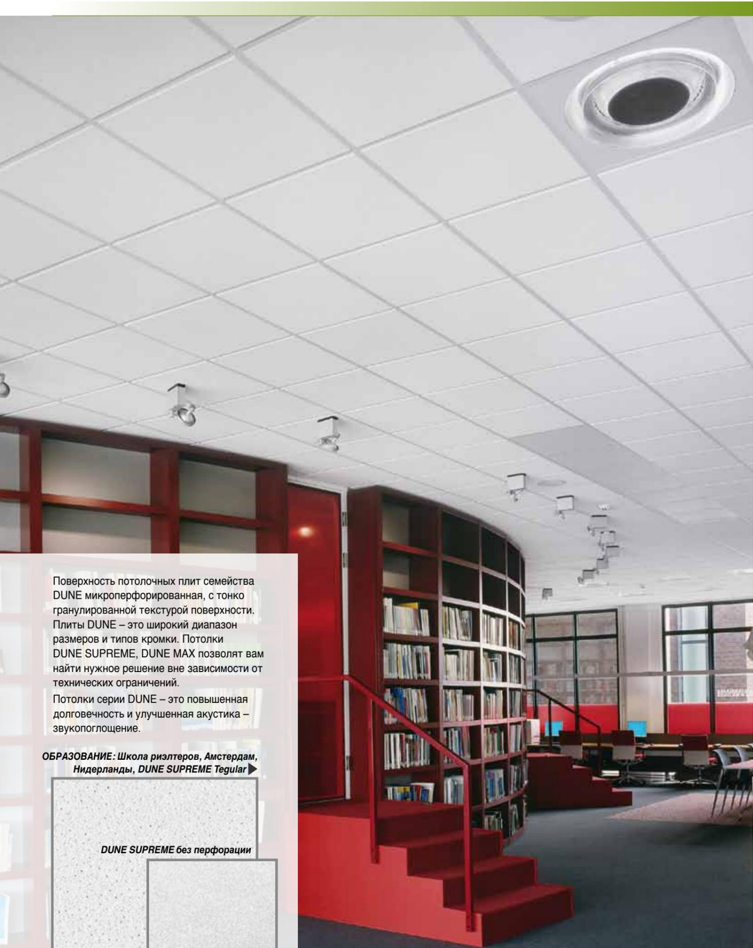
Поверхность потолочных плит семейства DUNE микроперфорированная, с тонко гранулированной текстурой поверхности. Плиты DUNE – это широкий диапазон размеров и типов кромки. Потолки DUNE SUPREME, DUNE MAX позволят вам найти нужное решение вне зависимости от технических ограничений. Потолки серии DUNE – это повышенная долговечность и улучшенная акустика – звукопоглощение.
